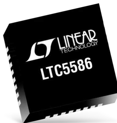
Рисунок 3.20 – Пасивний LTC5586 змішувач для понижувального перетворення
