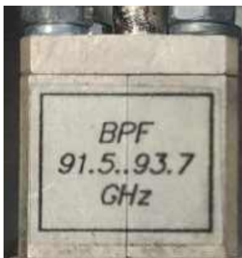
Рисунок 3.9 – Смуговий фільтр для виділення 15-ї гармоніки у передавачі
