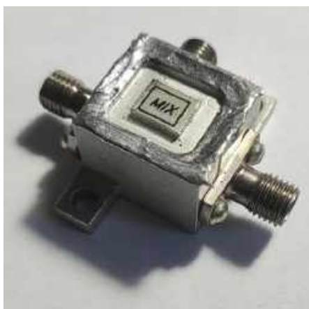
Рисунок 3.20 – Пасивний LTC5586 змішувач для понижувального перетворення
