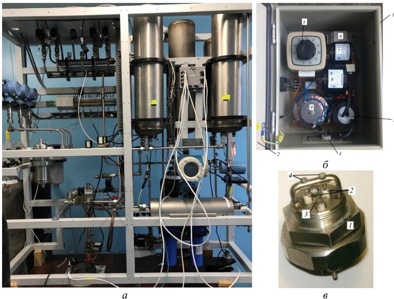
Рисунок 18 – Блок генерації паливної суміші (а), система запалювання (б) зі свічкою ініціації детонації (в) термоімпульсного обладнання
