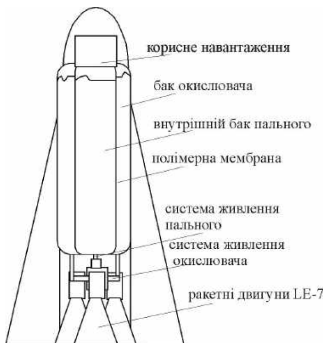
Рисунок 5.12 – Компонувальна схема японського космічного ступеня Норе-Х
