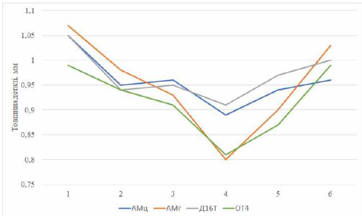
Рисунок 13 – Розподіл товщини деталей на відповідних ділянках
