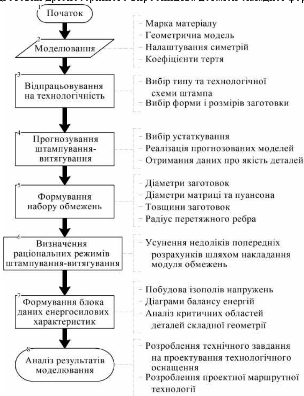
Рисунок 14 – Алгоритм технологічної підготовки виробництва штампування-витягування деталей складної форми
