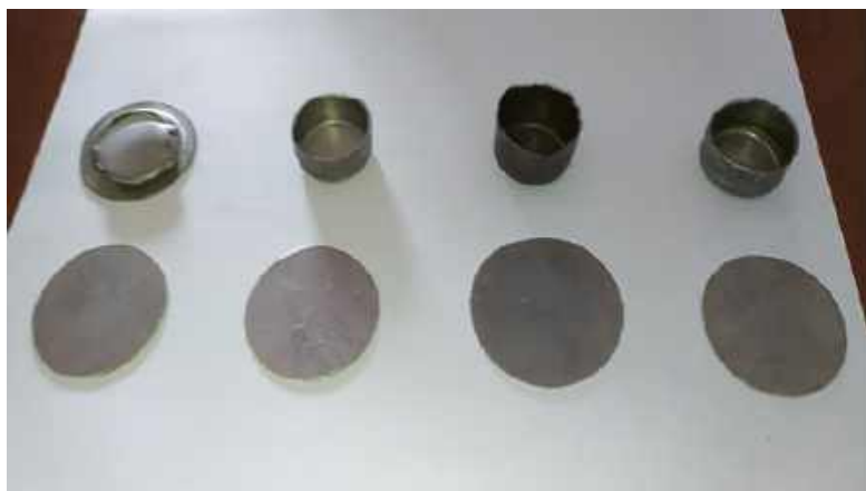
Рисунок 8 – Заготовки та деталі після розривного навантаження (зусилля)
