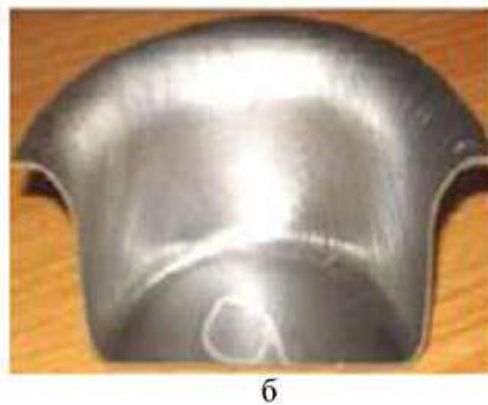
Рисунок 1.11 – Вимірювання товщини витянутого стакану: а – позиції вимірювання після розрізання витянутого стакану: б – розрізаний стакан [49]
