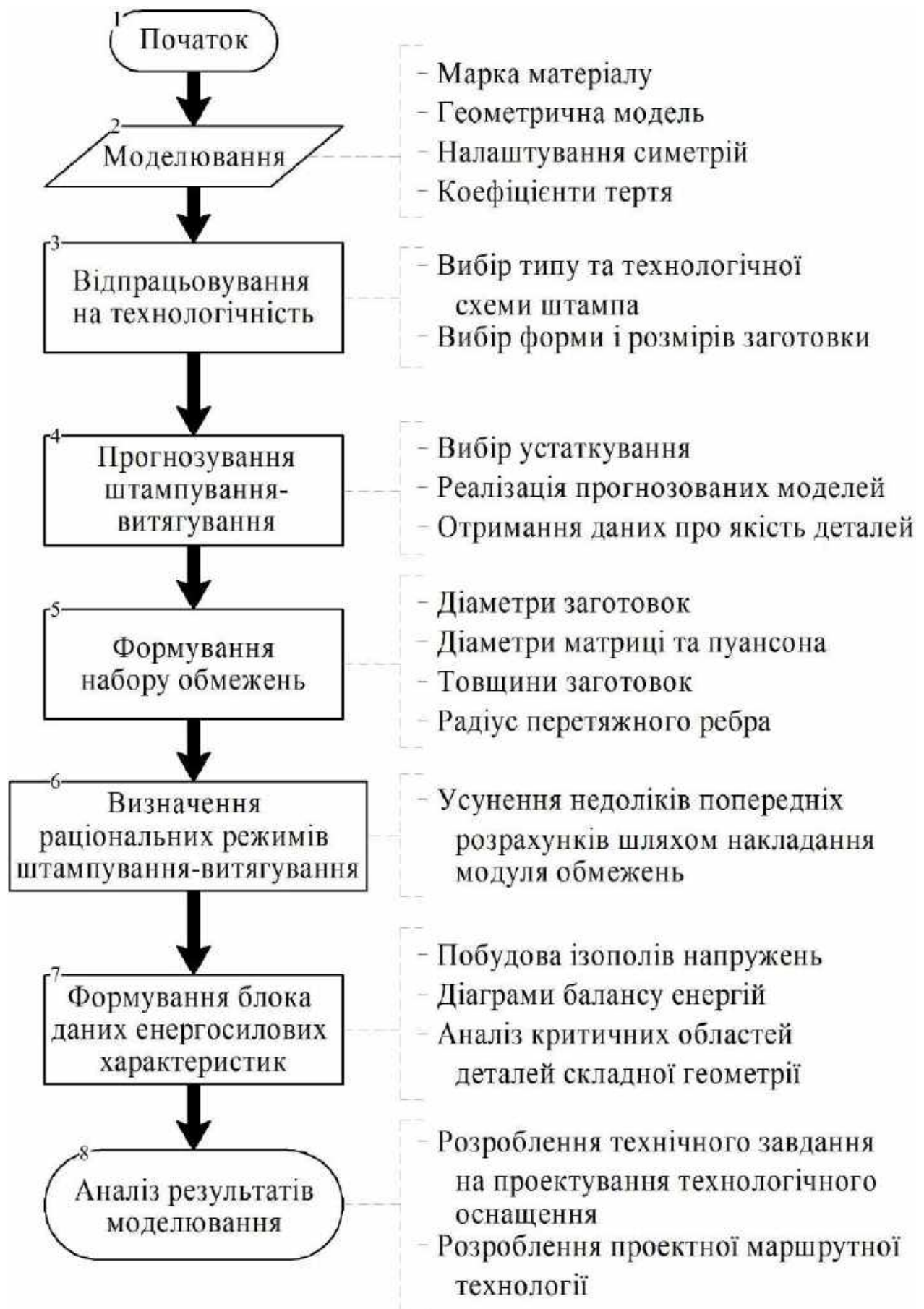
Рисунок 5.1 – Алгоритм технологічної підготовки виробництва штампування-втягування деталей складної форми
