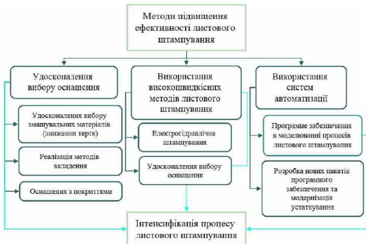
Рисунок 1.17 – Методи підвищення ефективності листового штампування
