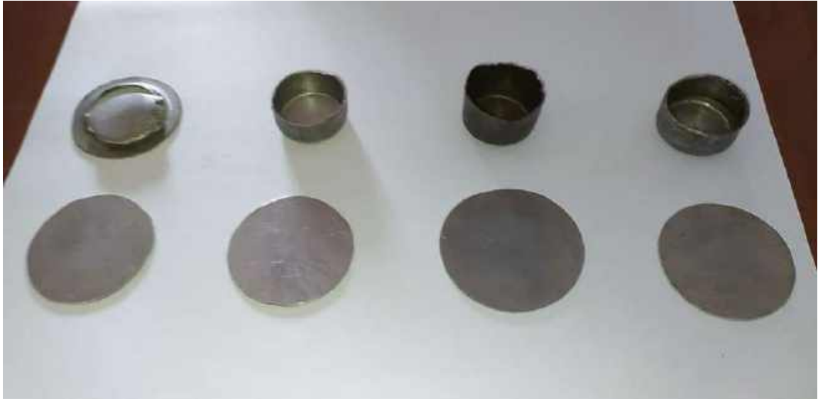
Рисунок 4.12 – Деталі після розривного навантаження (зусилля)
