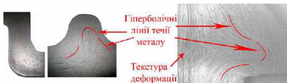
Рисунок 3.1 – Текстура деформації металу після кування[98]
