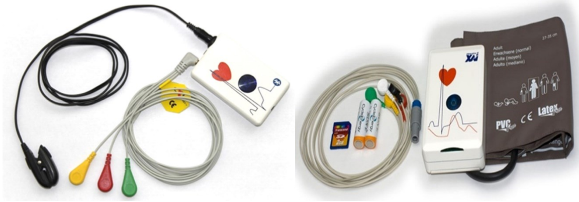
Рисунок 4.1 – Система для одно-канального запису сигналів ЕКГ та ФПГ (рисунок ліворуч) та CardioSens ECG + BP Holter Monitor Recorder (рисунок праворуч)
