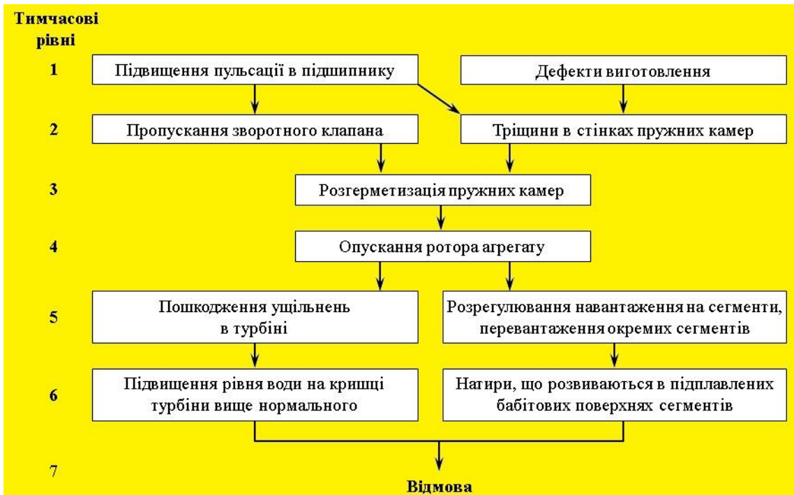
Рис. 3.4 – Схема розвитку дефектів пружних камер підп'ятника
