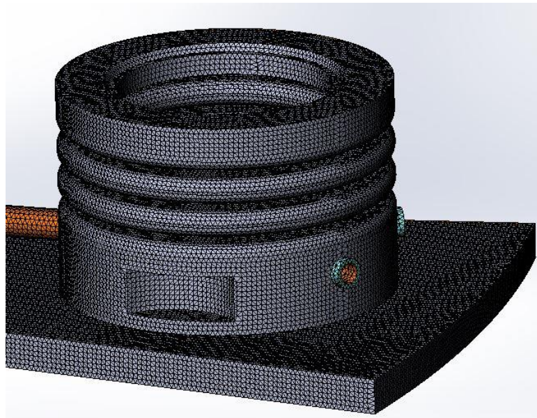
Рис.3.17 – Скінчено-елементна модель гофрованої камери зовнішнього ряду сегментів під'ятника
