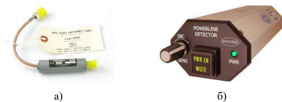
Рисунок 1.3 – Датчик фіксації електромагнітного поля (а) та система обробки, індикації та виводу звукового сигналу (взято з [47])
