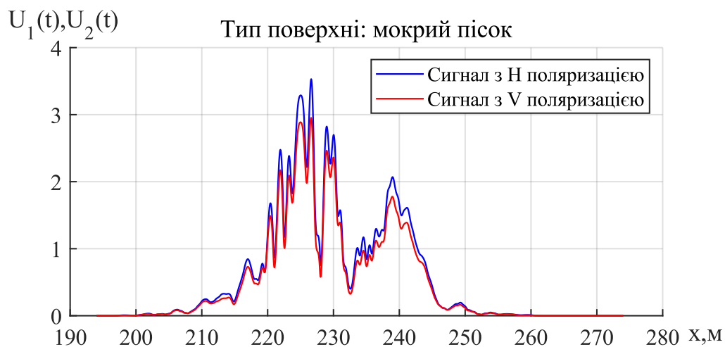
Рисунок 4.11 – Сигнали відбитий від земної поверхні мокрий пісок
