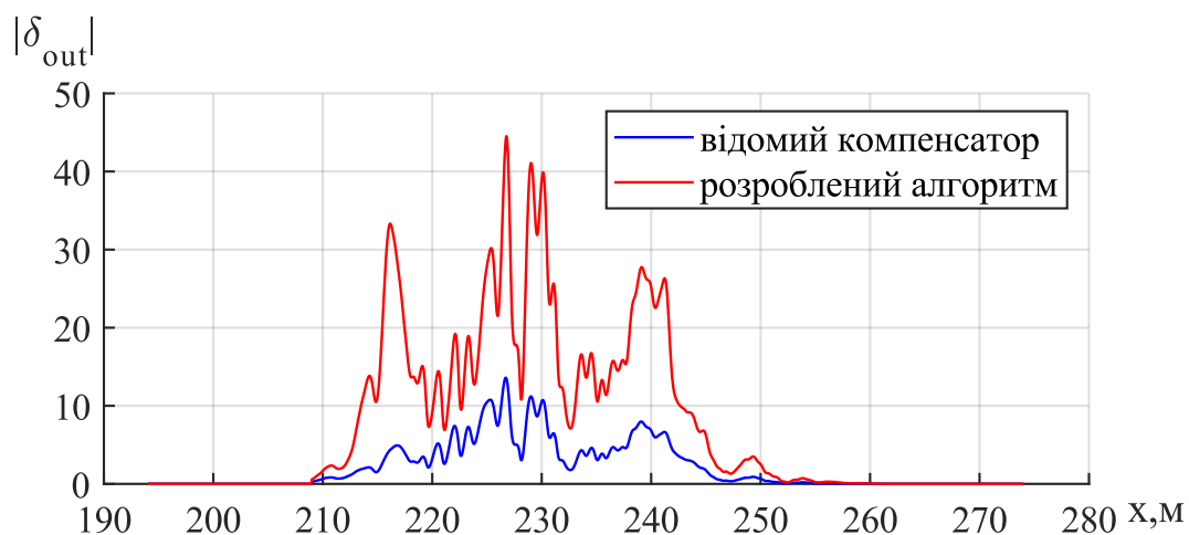
Рисунок 4.18 – Сигнал отриманий після компенсації завад (поверхня вода)
