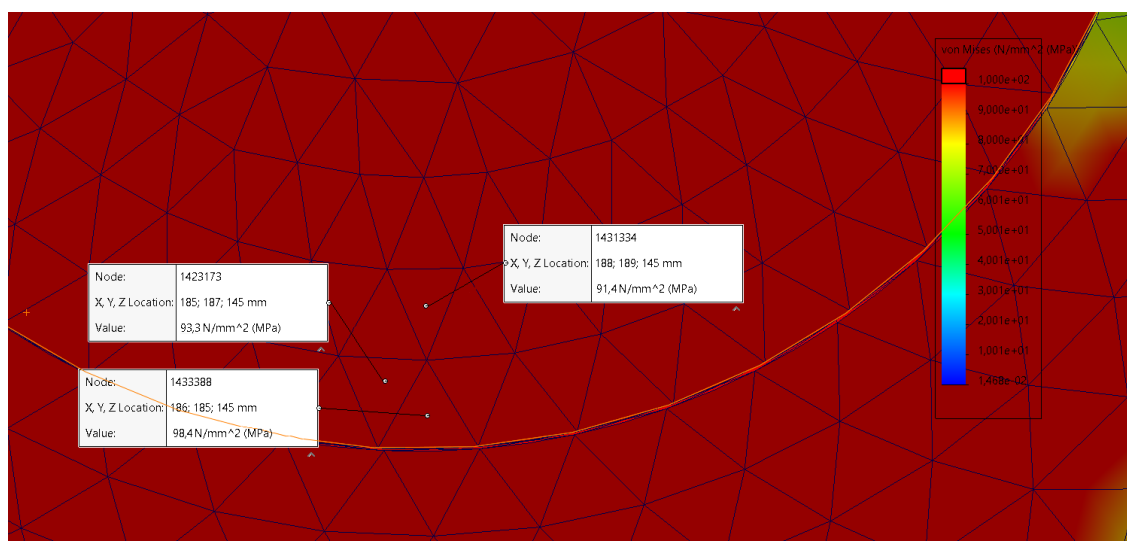
Рисунок 5.5 – Локальні значення напружень в підвісці для ділянки 2
