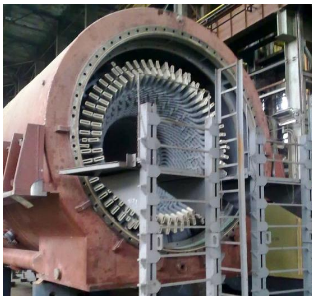
Рисунок 1.7 – Статор турбогенератора потужністю 300 МВт
