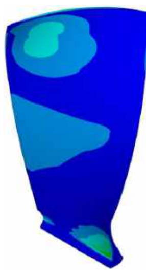
Рисунок 4.8. Результати п'ятої частоти 543.73 Гц
