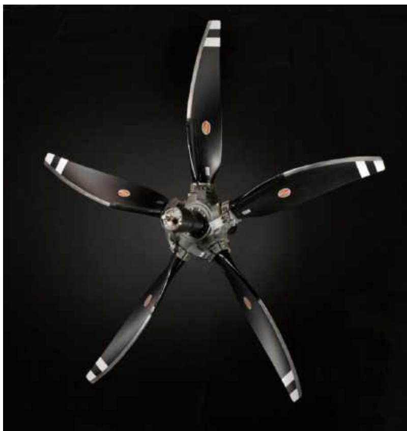
Рисунок 1.3. Повітряний гвинт Hartzell ASC-II
