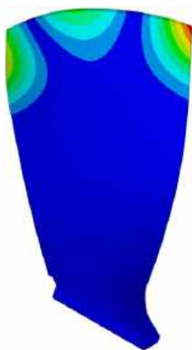
Рисунок 4.11. Результати восьмої частоти 834.43 Гц
