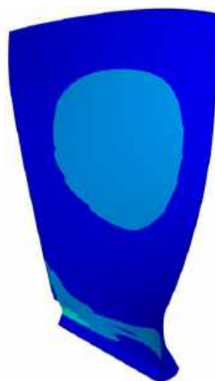
Рисунок 4.5. Результати другої частоти 169.61 Гц
