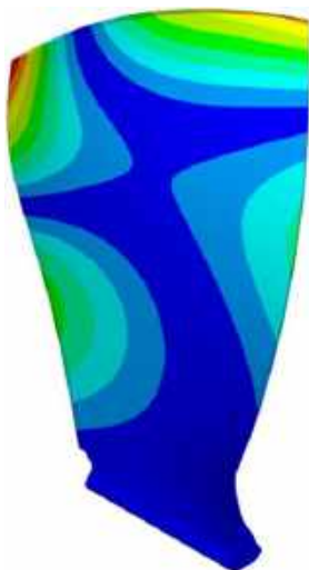
Рисунок 4.8. Результати п'ятої частоти 543.73 Гц
