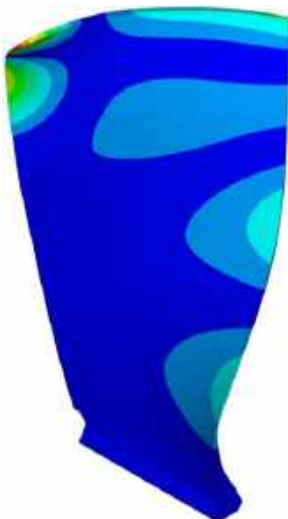
Рисунок 4.12. Результати дев'ятої частоти 978.89 Гц
