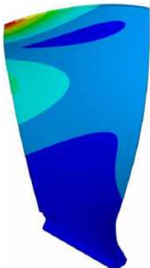
Рисунок 4.6. Результати третьої частоти 243.41 Гц
