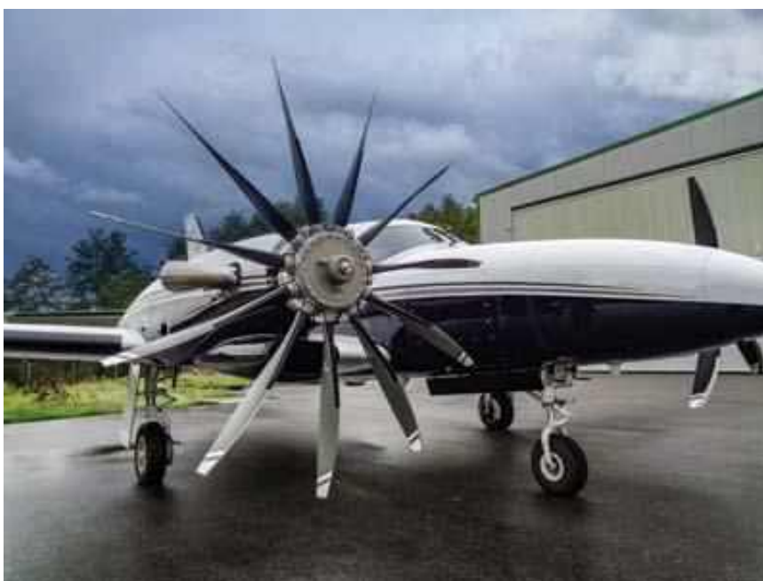
Рисунок 1.4. Перший 11-лопатевий повітряний гвинт MT-Propeller
