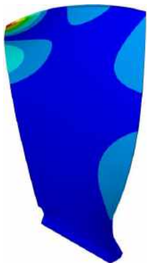
Рисунок 4.9. Результати шостої частоти 624.63 Гц
