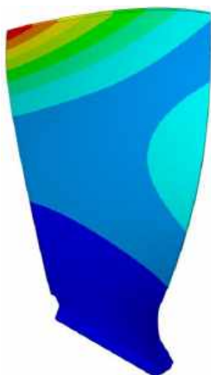
Рисунок 4.5. Результати другої частоти 169.61 Гц
