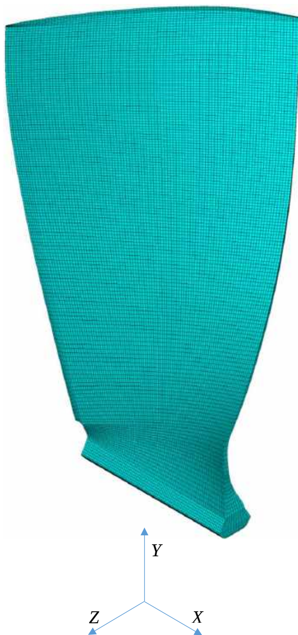
Рисунок 4.1. Скінченно-елементна модель лопатки вентилятора
