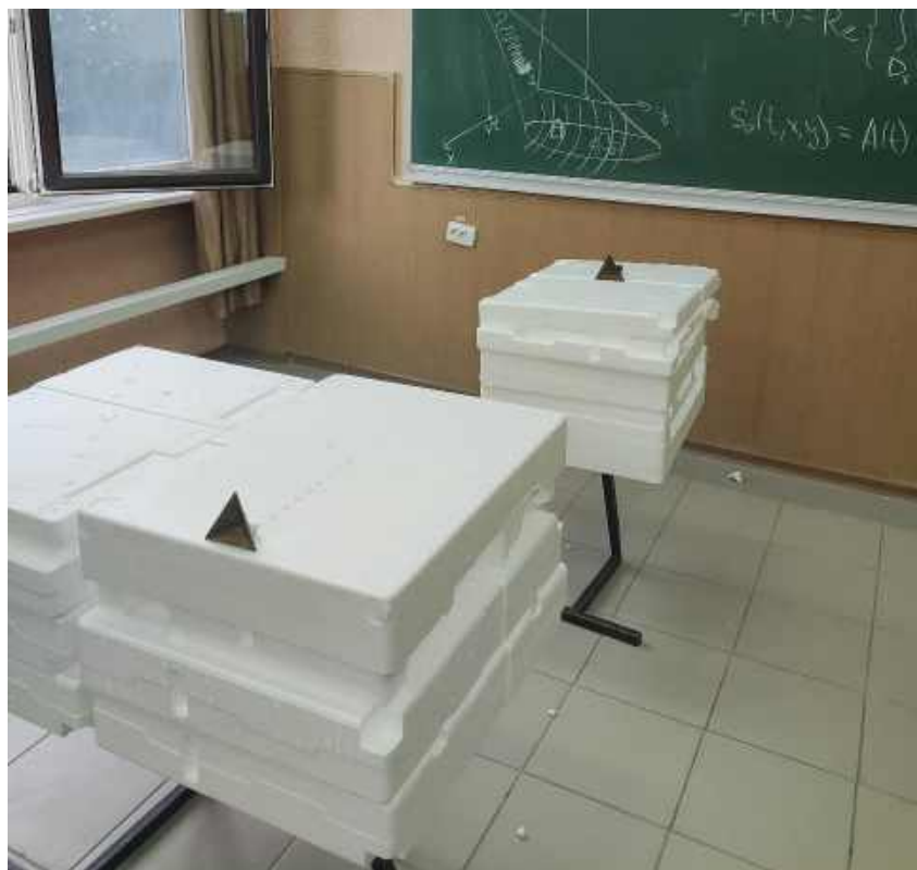
Рисунок 4.15 – Розміщення двох кутикових відбивачів один за одним на тестовому майданчику
