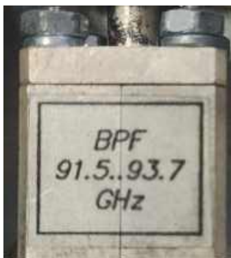
Рисунок 3.9 – Смуговий фільтр для виділення 15-ї гармоніки у передавачі
