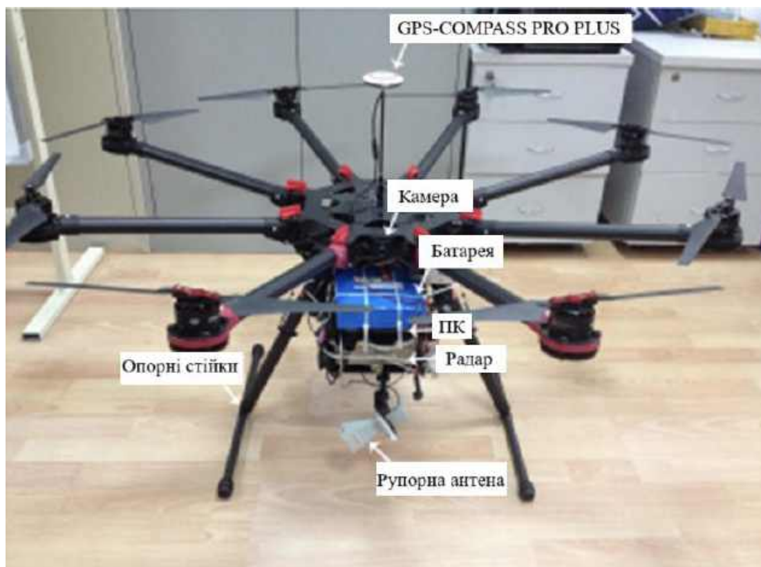
Рисунок 1.10 – БПЛА типу октокоптер укомплектований ЛЧМ РСА системою
