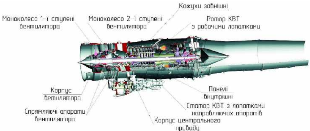
Рисунок 1.2 – Використання титанових сплавів в конструкції авіаційних газотурбінних двигунів (на прикладі ТРДД AI-222K-25)
