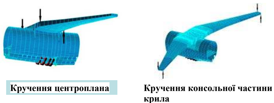
Рис. 27. Розрахунок НДС при дії ізолюваного крутного моменту і відсутності інших компонентів навантаження
